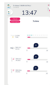
TURBINE LUMIÈRE Réglage de l'intensité de la lumière. Réglage des débits d'air et d'eau des sprays.
