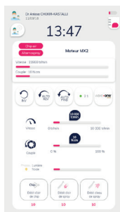
MOTEUR MX À INDUCTION Affichage et présélection de la vitesse des micro-moteurs. Réglage du couple et fonctions auto-reverse et auto-forward.
